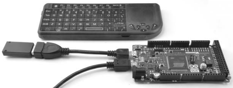
Rysunek 11.5. Klawiatura podłączona do Arduino Due za pomocą kabla Micro USB OTG Host
